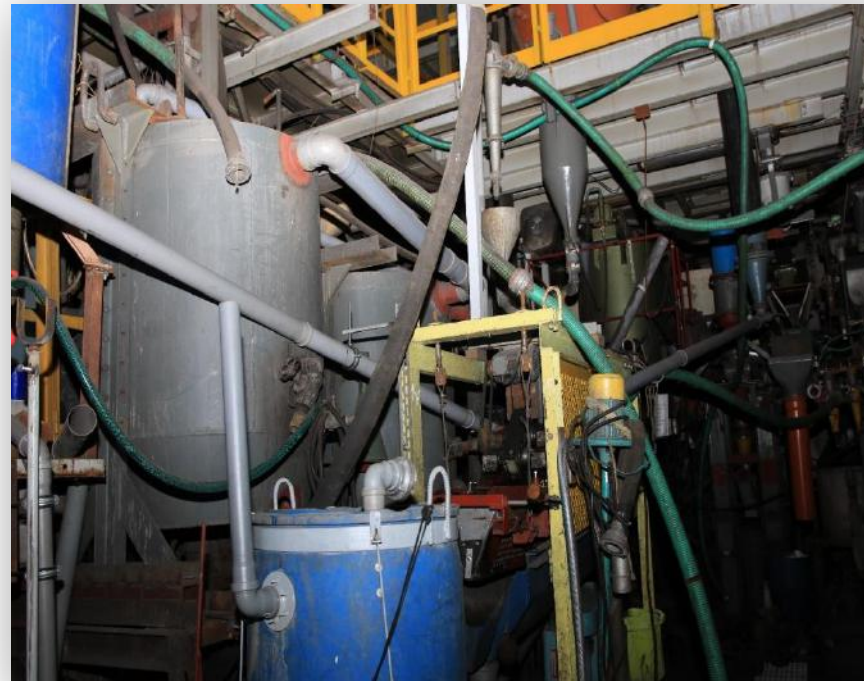
Główna sekcja klasyfikująco-odwadniająca muły pochodzące z osadników kopalnianych.
